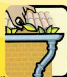
Remover tudo que possa impedir a água de correr pelas calhas
