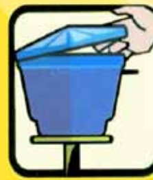
Fechar bem a caixa d'água e colocar tela no ladrão da caixa d'água
